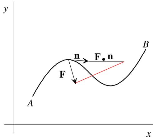
図11.2 ベクトルの接線方向成分
