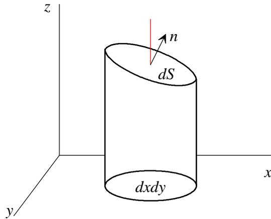
図11.3 平面 $dS$ の $x,y$ 平面への射影
