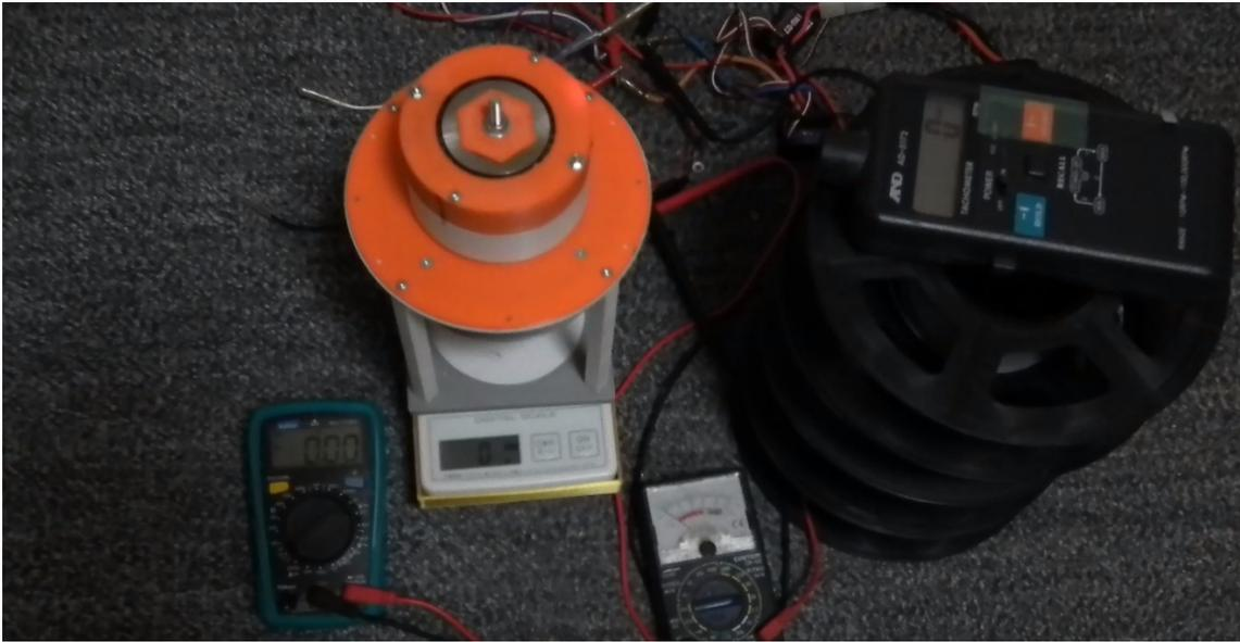
TR90/DSCF5102.mp4 は 5000[rpm]程度でコロ側が浮上して①に当たる（飛ばないように蓋をしている）が外周リングに接触しなくなるためコロが回らず、上下に振動するようになって、上方への推進力が一様に出るといいう理想からはほど遠いものになってしまった。
