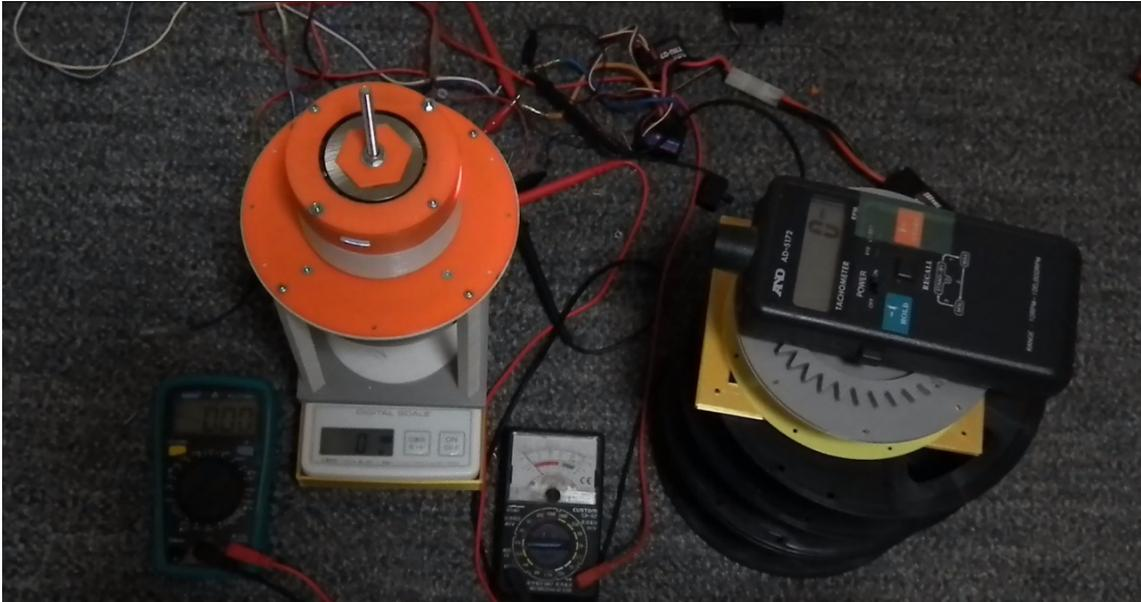
TR90/DSCF5119. mp4 は上下振動はなくなったようだが、上への推進力を得るためにコロを回そうとして下への推進力を上げるという本末転倒なことをしており、高回転の 8400[rpm] 程度で破壊的なことになって、この構造も理想的ではない。
