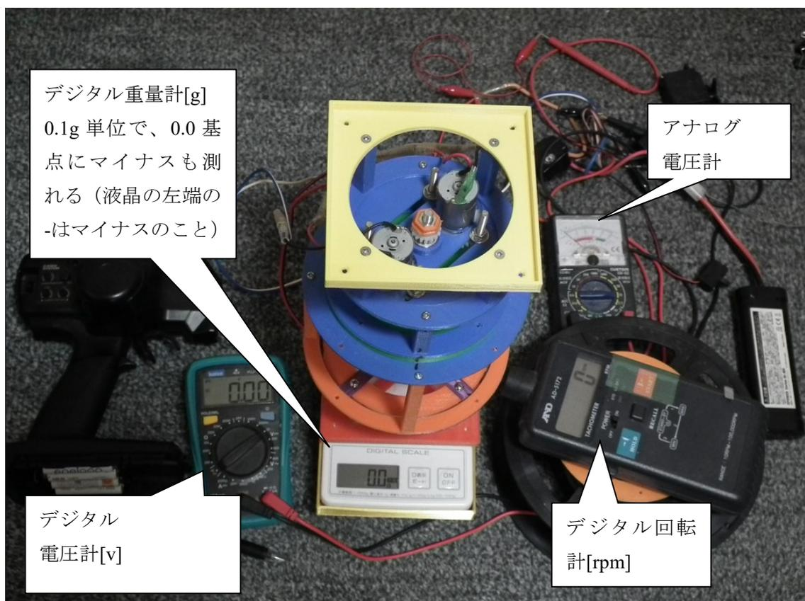
■ 2連装の円錐コロ軸受けによる推進力とエネルギー増幅の計測実験結果
